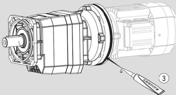
1. Aplicar Loctite 510 na superfície do flange e no anel de alinhamento.
