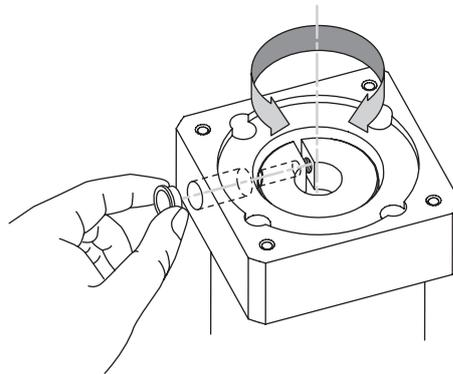
7. Direcionar o eixo do motor de modo que a chave fique alinhada à ranhura do eixo do redutor e ao disco de contração.
