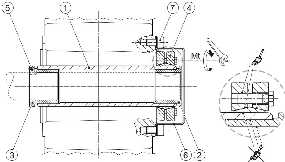
a) Limpar e desengraxar bem as superfícies de contato do eixo da máquina, eixo de saída do redutor (1), bucha elástica (2), bucha final (3) e disco de contração (4), com o disco de contração fora do cubo.
